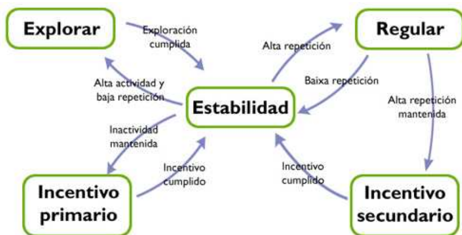
Figura 6: Autómata de los diferentes estados en los que se puede encontrar el módulo de toma de decisiones.
